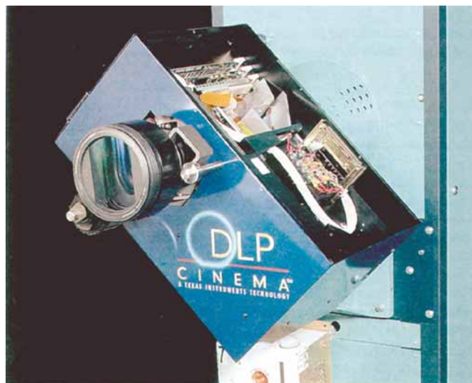
Prototyp eines DLP-Projektors von Texas Instruments/Christie mit geöffnetem Kopf. Das bei den Digitalmodellen eingesetzte Lichthaus (türkis) unterscheidet sich dabei nicht von denen gewöhnlicher Projektoren.
